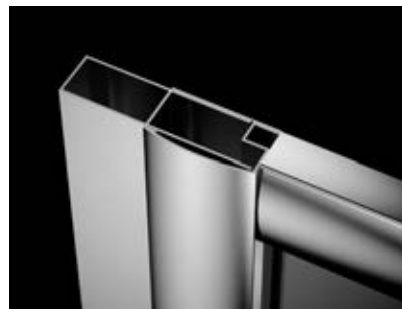
Premium Plus A, C, D, E, P – profil +4 cm. Standardowy profil U zastępujemy profilem poszerzającym P01-127190001.
